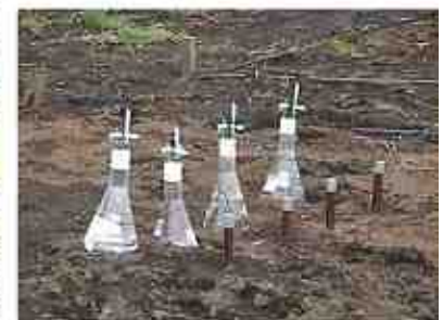
土壌中の溶液は、設置された フラスコの中に吸い上げられる
